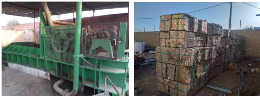
Photographie 5 : machine de compactage et ferraille compactée.
